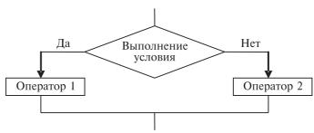
Сначала проверяется условное выражение  $\langle$ условие $\rangle$ . Если условие выполняется, то выполняется  $\langle$  оператор  $1\rangle$ , а  $\langle$  оператор  $2\rangle$  пропускается. Если условие не выполняется, то  $\langle$  оператор  $1\rangle$  пропускается, а выполняется  $\langle$  оператор  $2\rangle$ .
