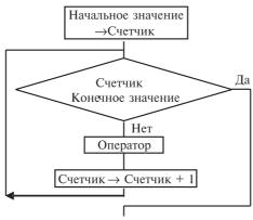
Рис. 5. Блок-схема выполнения счетного оператора циклов For
