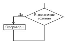
Рис. 3. Блок-схема условного оператора If — Then — Else — IfEnd
