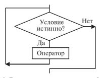
Рис. 6. Блок-схема оператора цикла While
