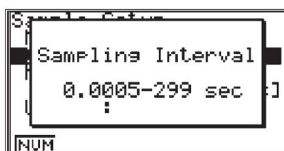
Шаг выбирается произвольно в рамках возможного интервала. От шага зависит точность проводимых измерений.
