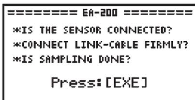
Параметры измерения были заданы в пунктах 3.2 и 3.3. Проверим подключение датчика и кабеля и нажмем **[EXE]**. Калькулятор приступит к подготовке *CLab* к проведению измерения. В это время на экране отображается информационно-диалоговое окно:
