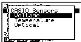
Клавишей **[REPLAY]** выделите нужный датчик (в данном случае Voltage – напряжение) и нажмите **[EXE]**. В строке CH1 справа от двоеточия появится надпись Voltage, означающая, что канал CH1 настроен на прием данных от датчика напряжения.
