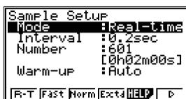
В строке Mode (режим проведения измерений) выберите режим измерений Fast (быстрый), нажав **[F2]** (Fast).
