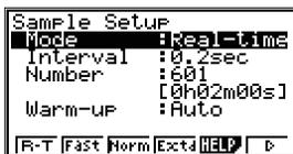
Клавишей **REPLAY** выделите строку Mode (режим проведения измерений). В ней задается наиболее удобный из встроенных режимов измерений. Режимы различаются диапазоном интервала между соседними замерами. Выберите режим Normal (нормальный), нажав **F1** (Norm).
