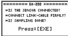
Параметры измерения были заданы в пунктах 2.2 и 2.3. Проверьте подключение датчика и кабеля и нажмите **[EXE]**. Калькулятор приступит к подготовке *EA-200* к проведению измерения. В это время на экране отображается информационно-диалоговое окно:
