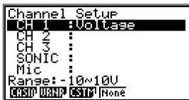
Переместите выделение на строку CH2 для настройки канала CH2 анализатора EA-200. Настройте его так же, как канал CH1:
