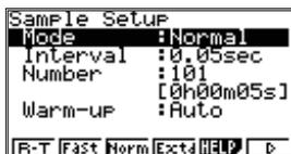
Переместите выделение на строку Interval (шаг). В этой строке задается временной интервал между соседними замерами, то есть шаг, в пределах выбранного режима проведения измерений.
