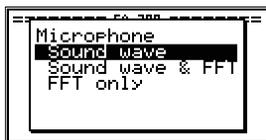
Sound wave – построение волнового графика – графика зависимости акустического давления в звуковой волне от времени;
