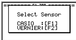
К измерительному комплексу можно подключать не только датчики CASIO, но и совместимые датчики других производителей. Но в автоматическом режиме возможен выбор только между датчиками CASIO и VERNIER.
